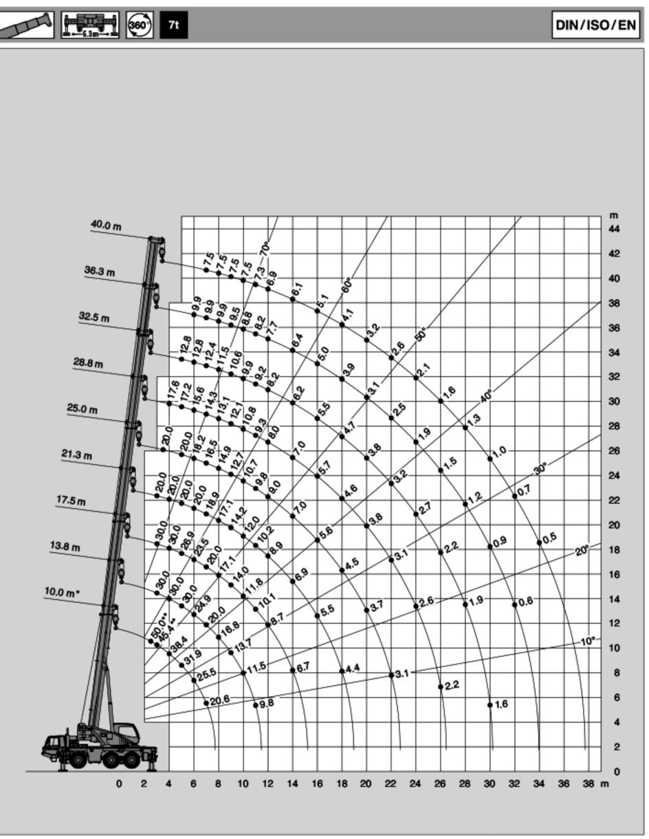
\* Nach hinten / \* Over rear / \* A l'arrière / \* Sobre la parte trasera Mit Zusatzhubausrüstungen / \*\* With additional litting equipments / \*\* Avec équipements supplémentaires / \*\* Con equipos adicionales
